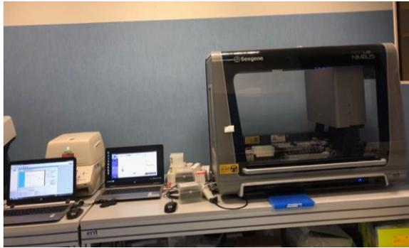
Figura1. Sistema estrazione e analisi automatizzato, capacità di processazione 40 test /seduta
