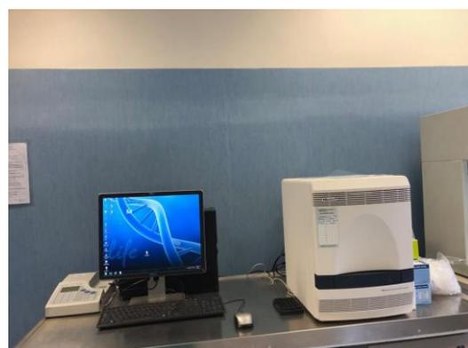
Figura 3. Estrattore automatico abbinato ad amplificatore di sequenze geniche virali, piattaforma di analisi custom on demand applicabile a differenti kit diagnostici COVID-19.
