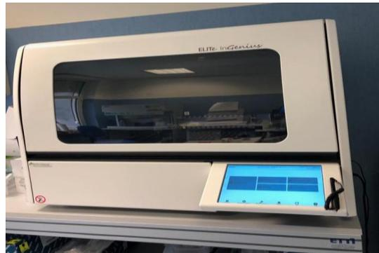
Figura 2 . Sistema estrazione e analisi automatizzato, capacità di processazione 12 test /seduta.
